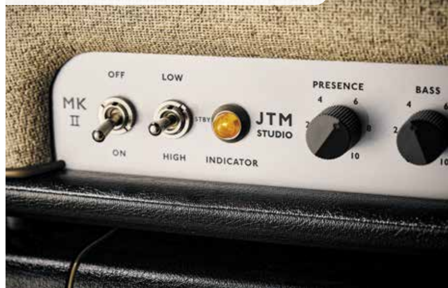
Met de standbyschakelaar kun je tevens het vermogen op 20 of 5 watt zetten
