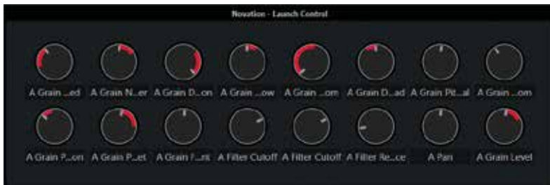
Als je hebt gekozen voor Pickup zie je in rood het verschil tussen de controllerknop en de knop in de plugin. Om onverwachte sprongen te voorkomen krijgt de controllerknop pas effect als hij de huidige stand van de knop op het scherm bereikt.
