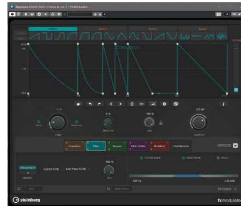
FX Modulator kan de parameters van zes effecten in serie dynamisch moduleren.
