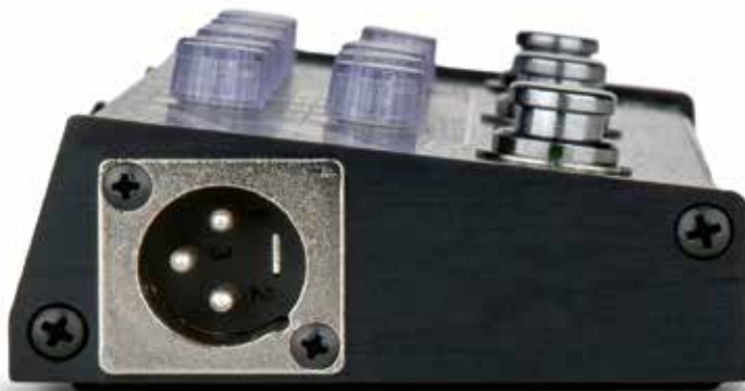
Met een xlr-uitgang kun je de pedalen rechtstreeks op PA of computer aansluiten
