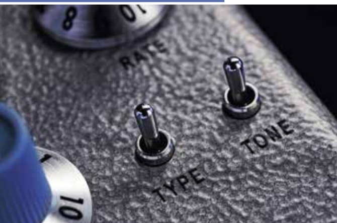
Tuimelschakelaars plus interne dipswitches geven de Hammertone pedalen extra geluidsmogelijkheden
