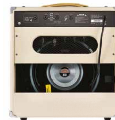
De open achterkant toont de Celestion Seventy 80 speaker die de combo zijn naam geeft
