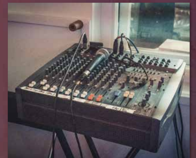
Deze Soundcraft Powered Mixer 600 staat in de live-room om onder meer Edgars zang en Otto's toetsen uit te versterken.
