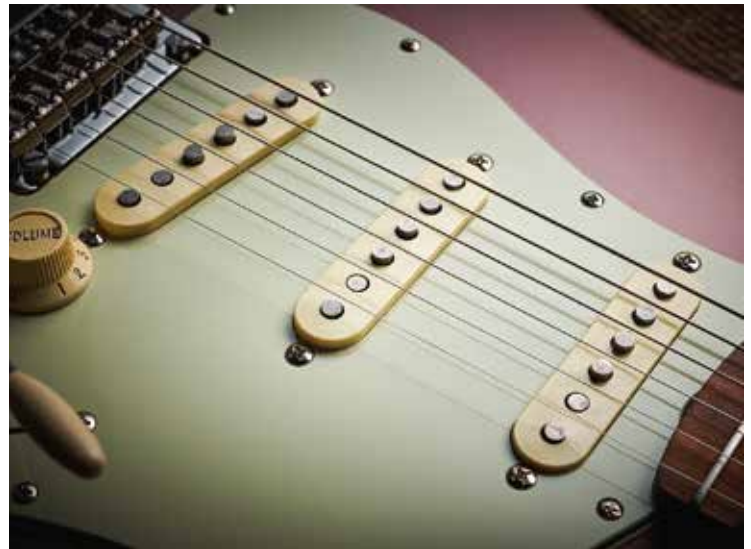
De '60's Strat-elementen hebben niet-afgeschuinde alnico V-magneten.
