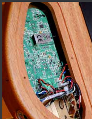
De door Fishman ontworpen grote printplaat met 380 componenten - dit is geen doorsnee Tele!
