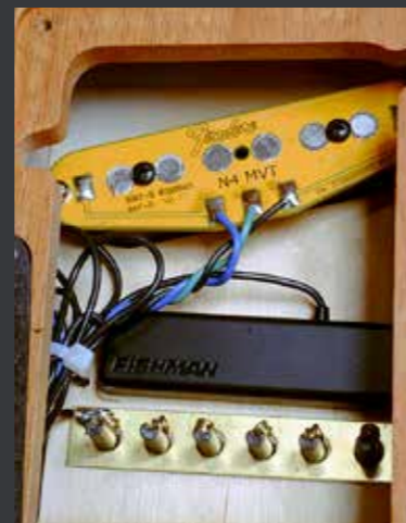
Naast de onder-zadel piëzo zijn er ook een brugplaattransducer en een Fender Noiseless pickup
