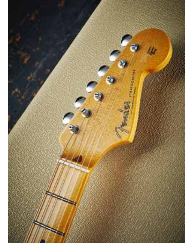
Door de in hoogte afnemende snaarasjes van de Gotoh stemmechanieken zijn geen snaargeleiders nodig
