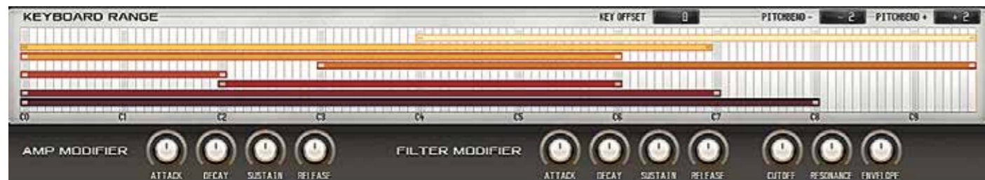
De acht layers van Rapid kunnen naar smaak worden gelayerd en gesplit, en in de Easy Strip regel je de envelopes en het filter voor alle layers tegelijk.
