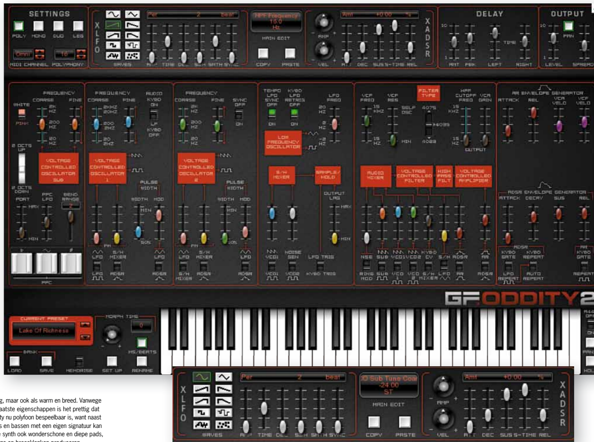
Vrijwel elke parameter op het Oddity-paneel kan worden gemoduleerd met een eigen lfo en envelope.
