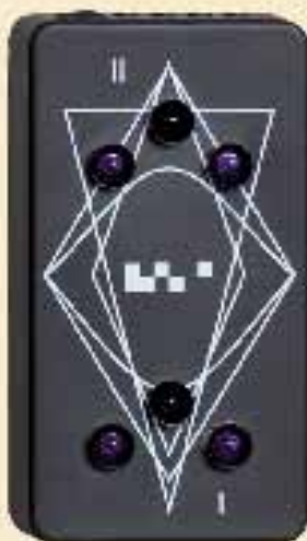
De Kommander cv-gate motion controller levert twee sensoren in een compacte behuizing.
