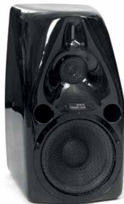
De 1022A uit 1985 was de eerste Genelec monitor met ronde (Barbapapa-)vormen, waardoor diffractie wordt geëlimineerd.
