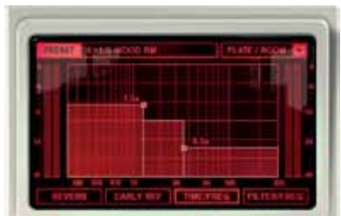
Figuur 1. Een aantal parameters is grafisch in te stellen, zoals hier de frequentieafhankelijke galmtijden.
