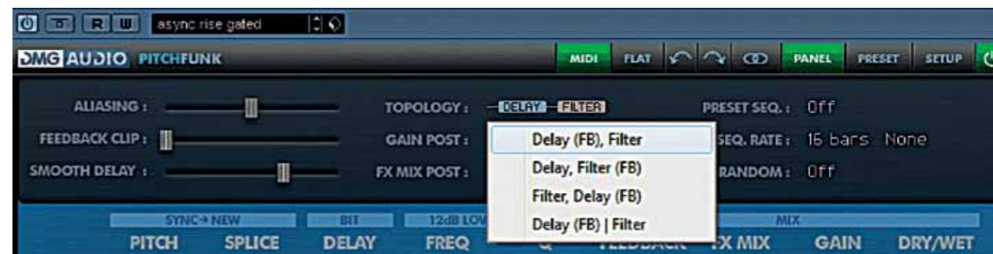
In Pitchfunk kun je het filter voor of achter de delay zetten, of in de feedbackloop van de delay.
